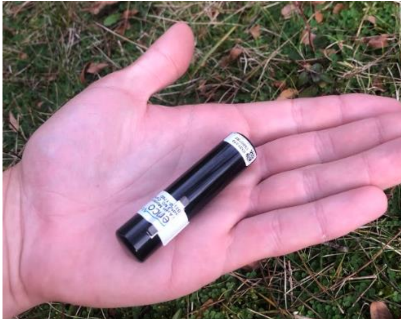
Figure 7. VEMCO V16-1L acoustic tag.
